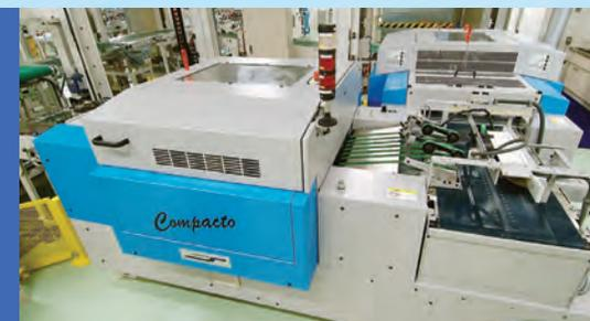
折機から出た印刷物を規定のサイズに断裁できます。ページ物の三方断裁、規格B4仕上げ、長B3仕上げ等、従来の製本工程で行っていた断裁作業が無いため、短納期の物件にも対応できます。
