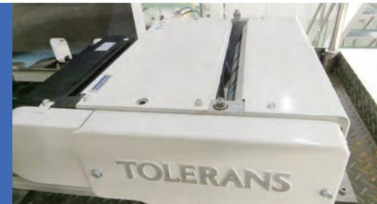
B4(タブロイド版)のページ物をインラインで中綴じすることができます。後工程での加工が無いため、作業工程を大幅に短縮できます。
